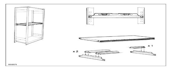
Die Querprofile der Verstärkung zwischen den hinteren und vorderen Stützen einbauen und Verstärkungsprofil(e) in den Querprofilen einhängen.
