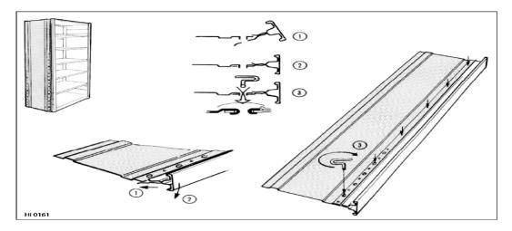
Jedes Verkleidungselement ist mit 12 Stauchverbindungen (je Stütze 6) zu befestigen, angeordnet am Kopf, Fuß und der Rest gleichmäßig verteilt.
