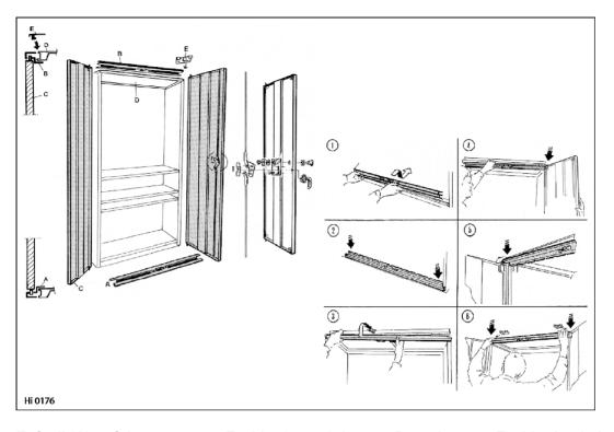
Fußteil (A) auf den untersten Fachboden anbringen. Den obersten Fachboden heben und das Kopfteil (B) in der gleichen Weise anbringen (3).
