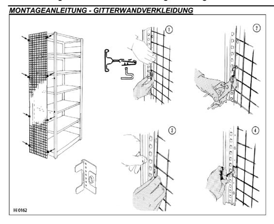
**Hinweis:** Gitterelemente dürfen nur an Rahmen angebracht werden, die bereits mit Streben oder mit Stegblechen und Streben ausgesteift sind. Das Gitterelement ersetzt diese Teile nicht.
