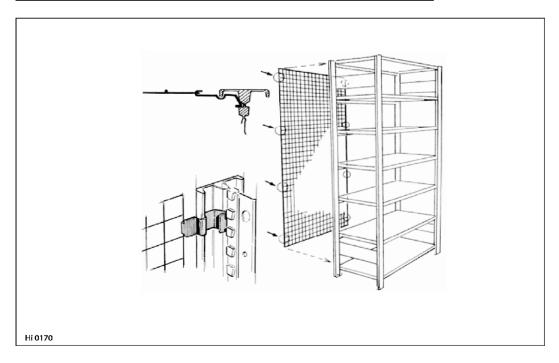
Jedes Element wird mit 8 Klammern befestigt – je Seite 4 Klammern, angeordnet am Kopf, am Fuß und gleichmäßig dazwischen verteilt.
