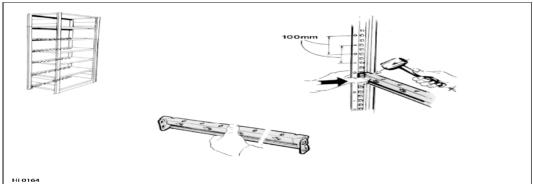
Der Fachbodenträger, weist an beiden Enden 2 Haken auf und unterstützt die Hinterkante des Fachbodens. Er wird deshalb nur zwischen den hinteren Stützen angeordnet. Weitspannträger, die an beiden Enden 3 Haken aufweisen, werden paarweise eingesetzt. Der erste Träger wird zwischen den hinteren Stützen und der zweite Träger zwischen den vorderen Stützen angeordnet.
