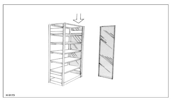
Das Element wird von oben vorsichtig eingelassen, damit die dekorative Oberfläche nicht beschädigt wird.
