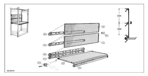
Die Arbeitsplatte und Werkzeugwand sind zur Anbringung in ein 1500 x 1500 mm Feld vorgesehen.
