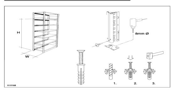
Sämtliche Regale, die mit Schubladen bzw. ausziebaren Tabletts ausgestattet sind, MÜSSEN am Fußboden befestigt werden.
